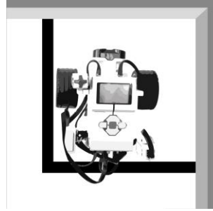
Robotun izdüşümü tamamen içeride, kablolar dışarıda. Bu durum kabul edilir.
